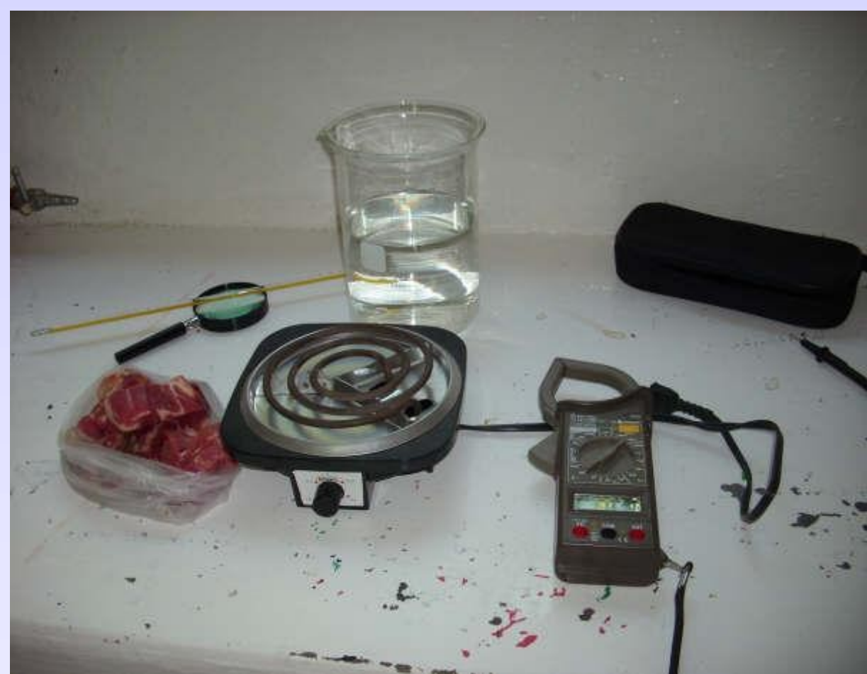
Fig 1. Material utilizado durante la experimentación: carne (costilla, 100g), estufa eléctrica, multímetro, vaso de precipitados de 2000 ml.
