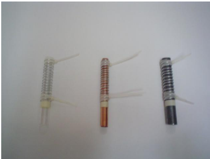
Figura 1. De izquierda a derecha, tubo de plástico, cobre y acero; y los cables de aluminio, zinc galvanizado y fierro. Utilizados por el Dr. Uruchurtu
