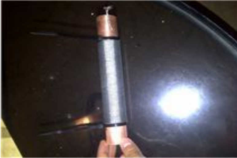
Figura 2. Técnica de alambre sobre tornillo donde el tubo es de cobre y el alambre es de acero, el sistema utilizado para este proyecto.
